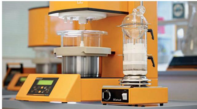
Abbildung 6: FIBRE THERM und manuelles FibreBag System von C. Gerhardt
