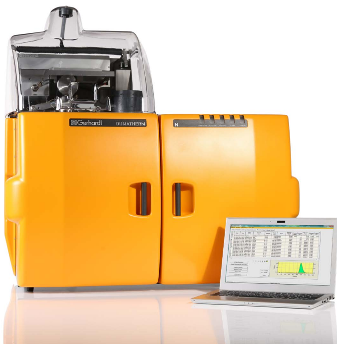
Abb. 1: Analysengerät DUMATHERM mit automatischem Probengeber und PC Steuerung
