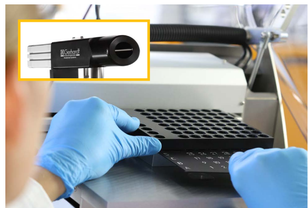
Abb. 2: Probengeber mit Spülfunktion - Modell Duo (kleines Bild) für geringes Probenaufkommen und Probengeber für hohen Probenumsatz mit großem Probenblett. Über die Helium-Zufuhr wird eine Spülkammer kontinuierlich gespült, bevor die Probe der Verbrennung zugeführt wird.
