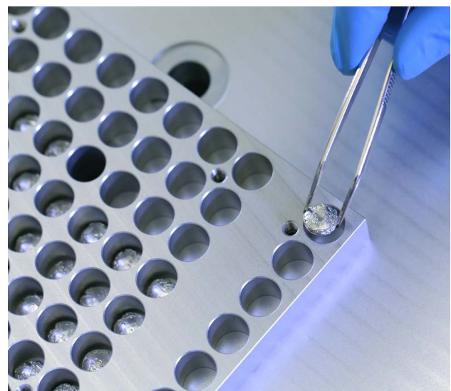
Abb. 4: Einwaage der Proben in Zinnfolie und Lagerung im Probenblech (rechts) bis zur Probenabgabe in den Probengeber.
